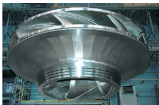
ポンプ水車ランナ (東京電力リニューアブルパワー株式会社様) Pump - turbine Runner (TEPCO Renewable Power, Incorporated)
