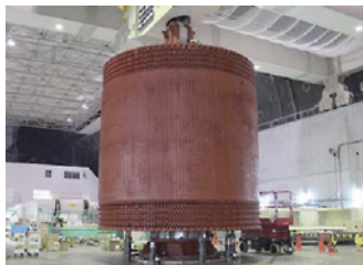
可変速発電電動機ロータ (東京電力ホールディングス株式会社様) Adjustable Speed Generator - Motor (Tokyo Electric Power Company Holdings, Inc.)
