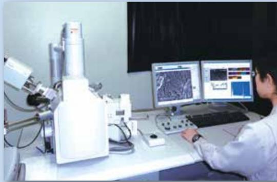
走査型電子顕微鏡・電子プローブマイクロアナライザ
