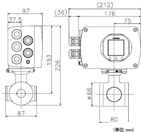
図4 一体形電磁流量計 LF410/LF620
