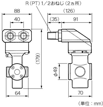
図6 分離形検出器(呼口径：15mm、質量約4kg)
