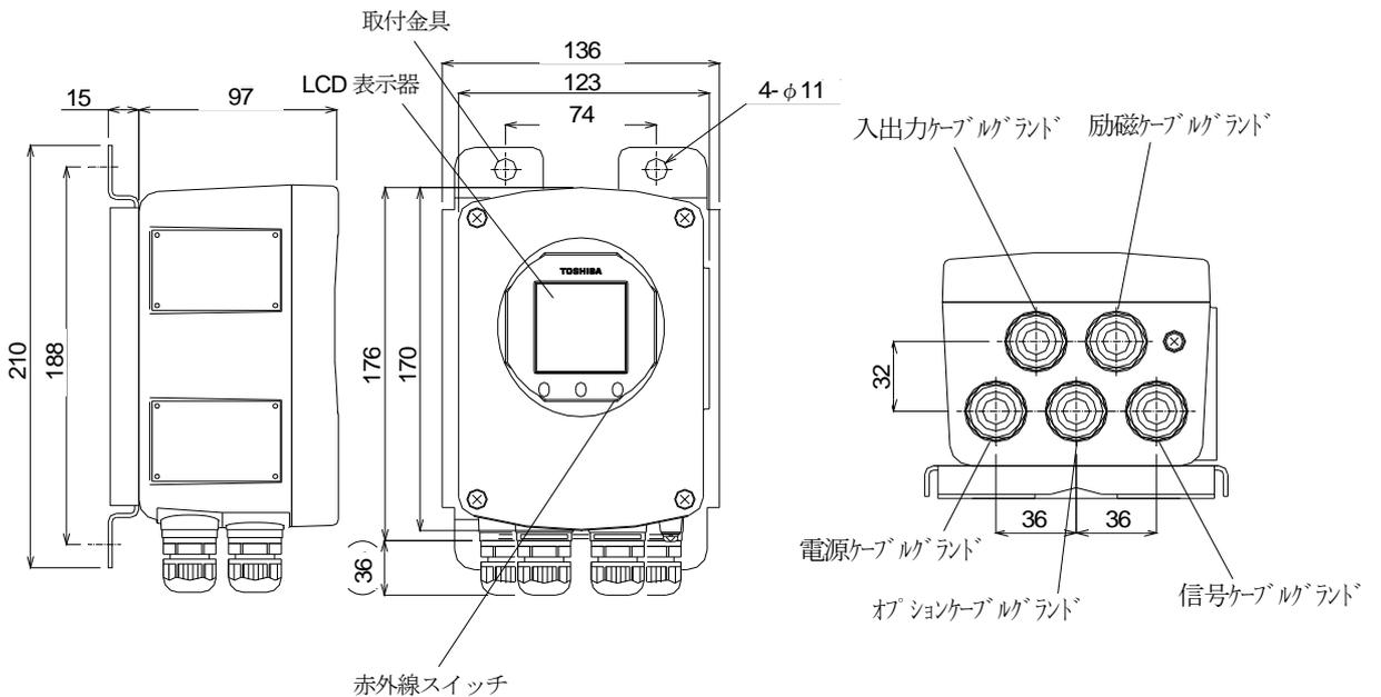
図9 分離形変換器 LF622 形(取付金具含む、質量約3kg)
