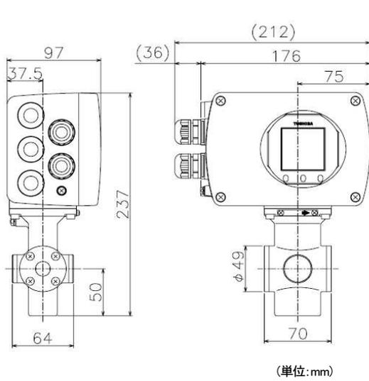
図3 一体形電磁流量計 LF410/LF620
