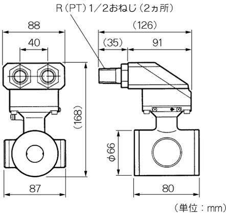
図7 分離形検出器(呼口径：25mm、質量約4kg)
