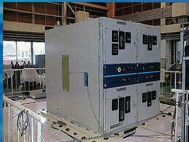
耐震試験状況
