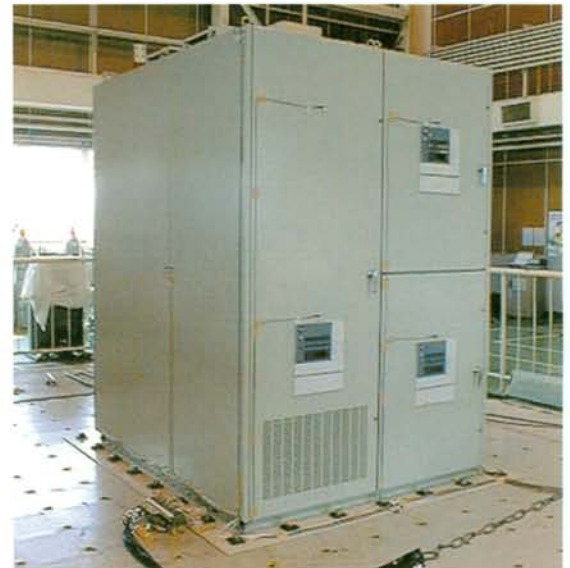
●VU2形スイッチギヤ実地震波試験風景
