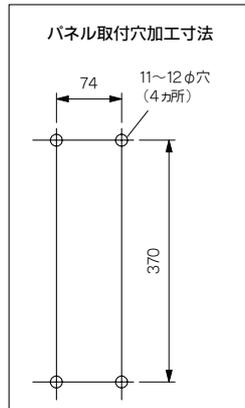
図5 変換器外形寸法図
