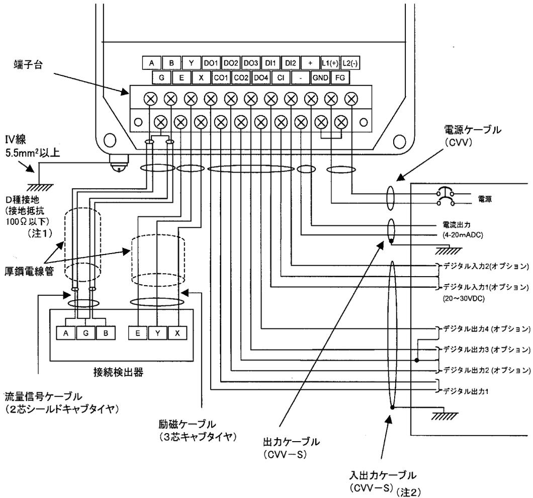
注1) 接地は変換器ケースに設けられた接地端子、もしくは変換器端子台のFG端子のどちらかで接地してください。
