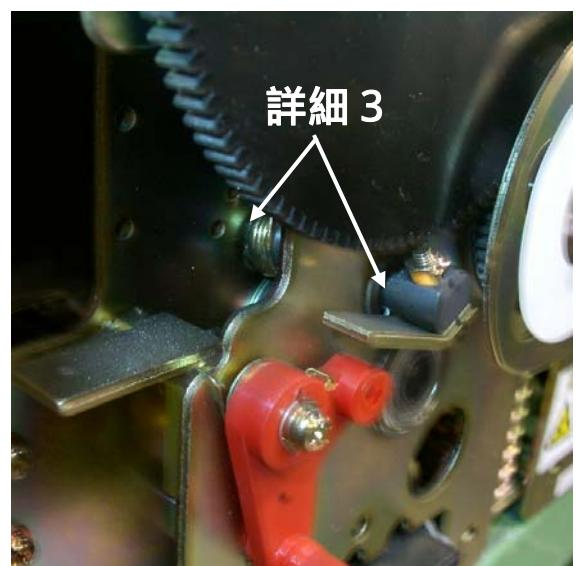
図 14 . 給油・注油箇所図 1
