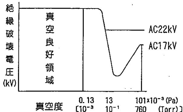
図 19. 絶縁破壊特性
