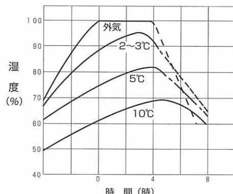
図3 外気湿度100%持続時間に対する箱内湿度の変化
