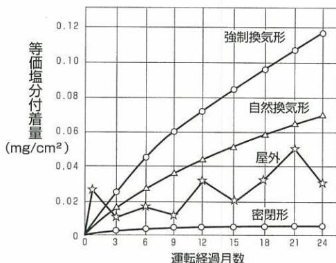
図2 閉鎖配電盤の形による累積汚損量
