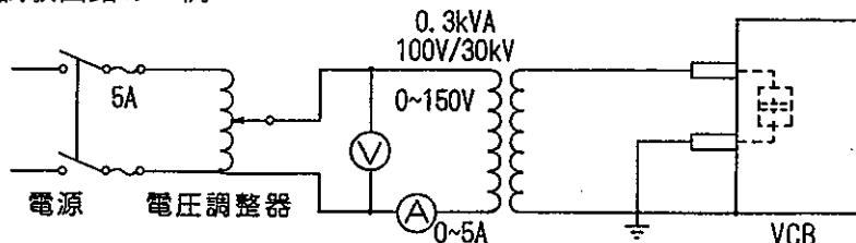
図 20. 耐電圧試験回路の一例
