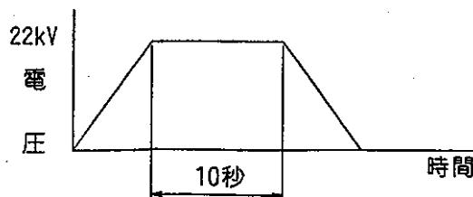
図 21. 電圧印加方法
