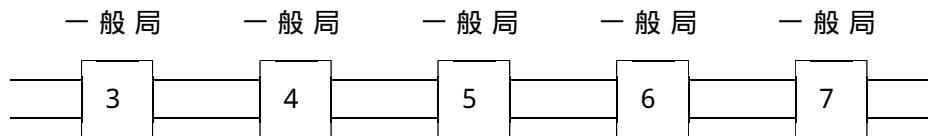
図 3 . 1 5 局 4 と 5 の間のケーブル断線
