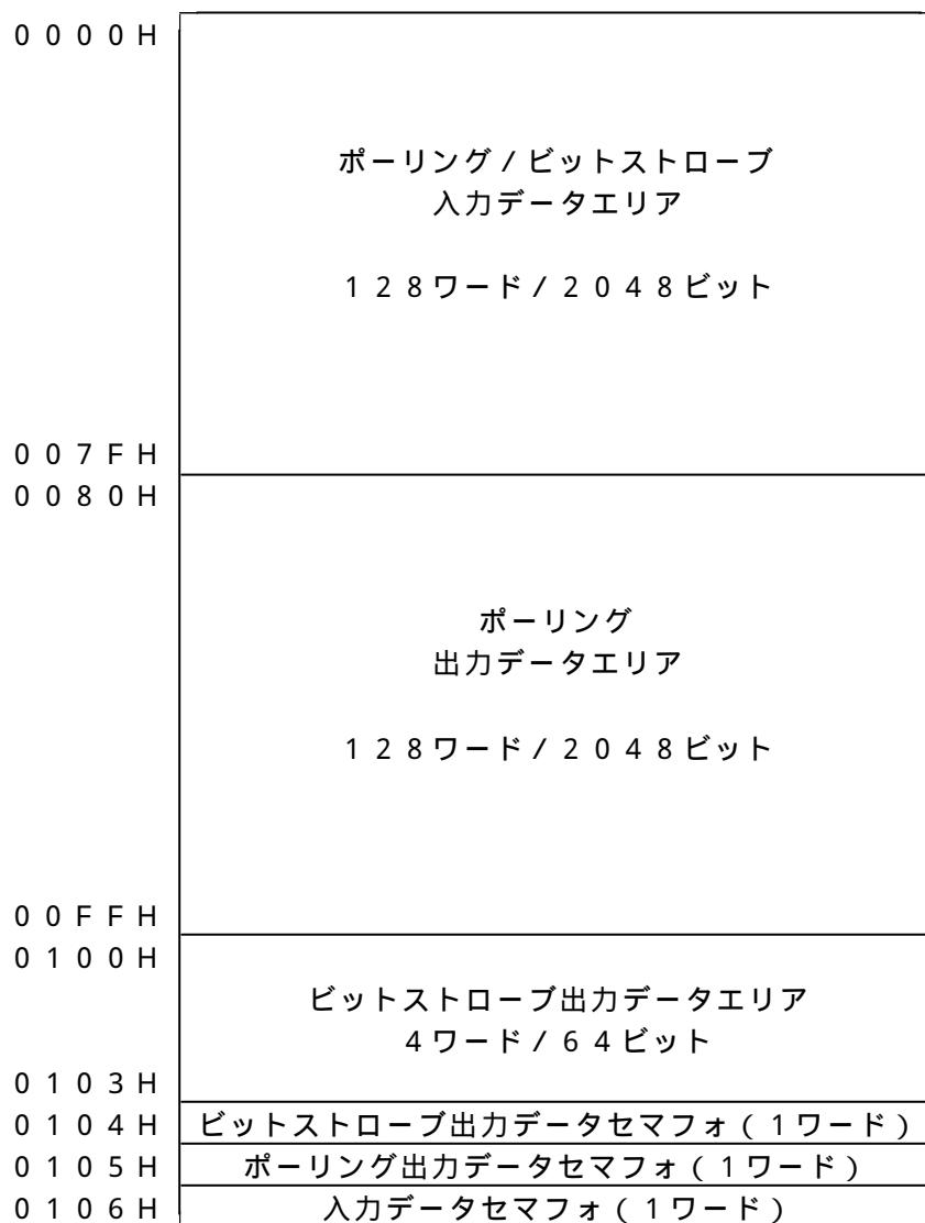
図4.2 入力 / 出力データエリア構成
