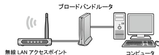
コンピュータと無線LANアクセスポイントを接続しているLANケーブルの無線LANアクセスポイント側をはずし、ご使用のブロードバンドルータへ接続する。ご使用のブロードバンドルータと無線LANアクセスポイントを接続する。
