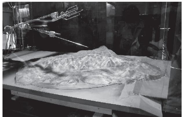
図2. 実地形のモデルを用いた風洞試験
