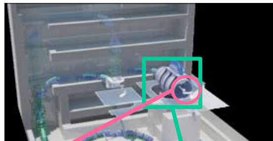
大型低温重力波望遠鏡（KAGRA）に設置したクライオスタット 〔©ICRR/KEK〕
