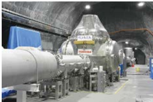
大型低温重力波望遠鏡（KAGRA）に設置したクライオスタット 〔©ICRR/KEK〕
