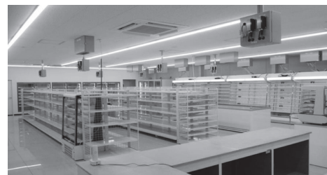
図3. 標準レイアウトのコンビニエンスストアを模擬した試験室
