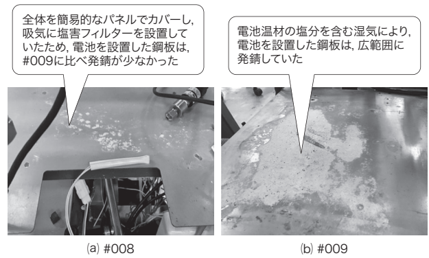
図4. パッケージ内部の目視検査結果
