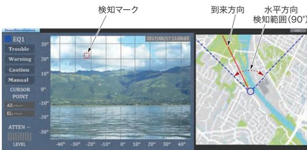
監視制御端末でのドローンの検知例
