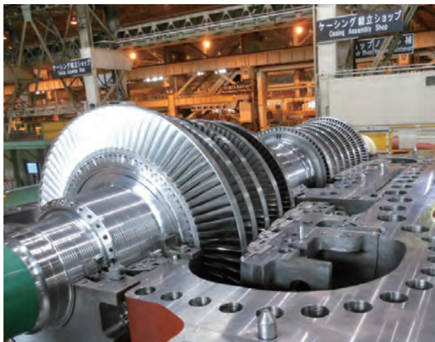
高中圧タービンの工場での組み立て
