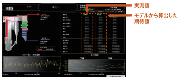
プラント性能監視の画面例 Example of plant performance monitoring display
