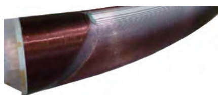
3次元巻き線機で製作した高精度湾曲くら型コイル
