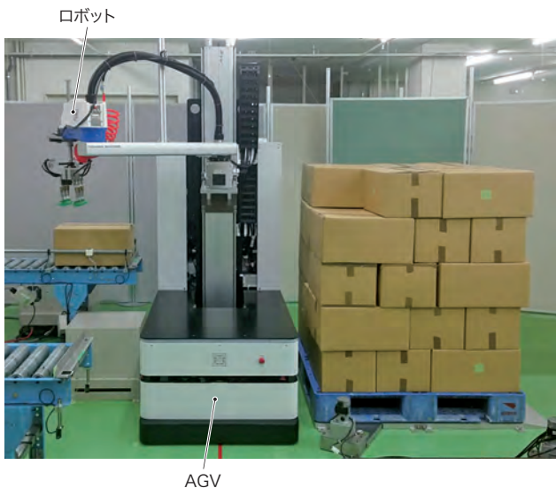
移動式パレタイザー Mobile palletizer capable of handling multiple conveyor lines
