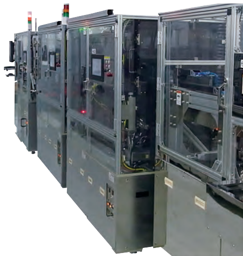
He 充填 HDD 用レーザー溶接封止自動化ライン
