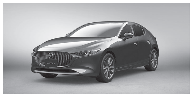
図1. バッテリーパックを搭載した MAZDA3 のマイルドハイブリッド車 バッテリーパックは、車体のフロア下部に設置され、車両減速時の回生エネルギーを回収・貯蔵し、24 V 電源として使用する。 Mazda3 equipped with 24 V SCiB™ battery pack
