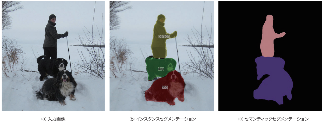
図1. インスタンスセグメンテーションとセマンティックセグメンテーションの例 画像領域分割には、個体ごとに領域分割するインスタンスセグメンテーションと、物体の種類ごとに領域分割するセマンティックセグメンテーションがある。 Examples of instance segmentation and semantic segmentation tasks
