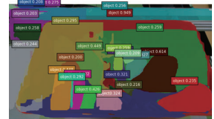
(c) 開発した物体領域抽出技術 物体の種類を区別せずに学習
