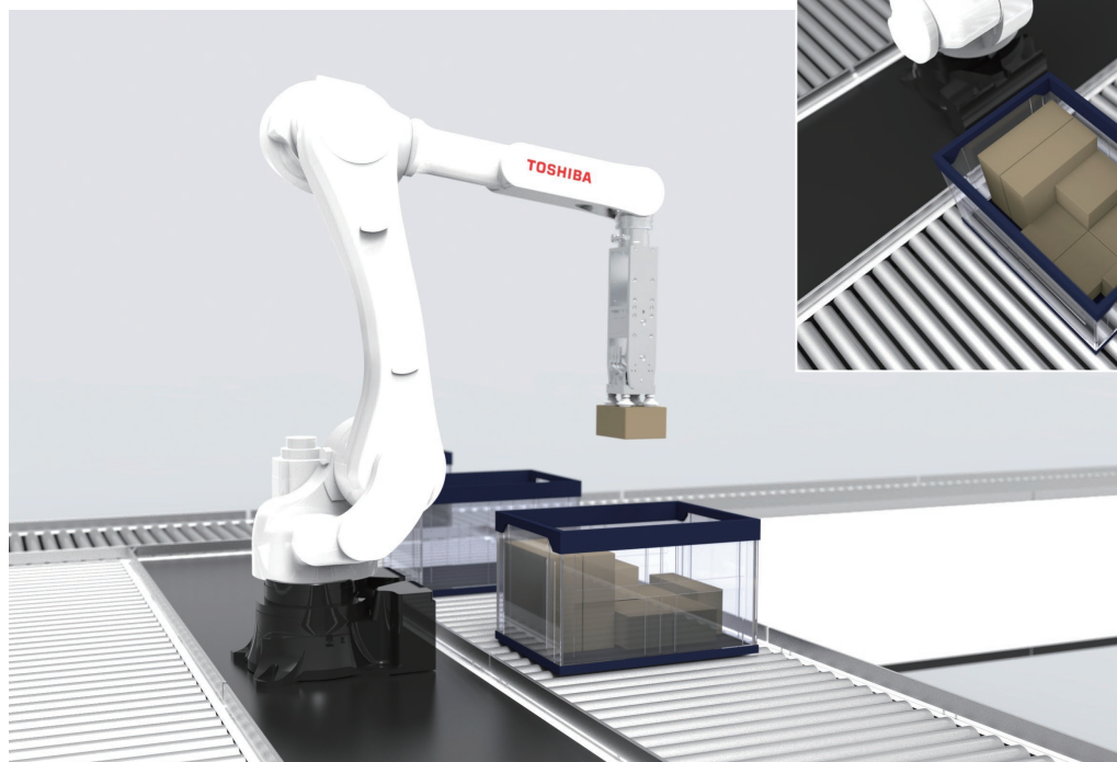
ピースピッキングロボット Piece picking robot for logistics operations
