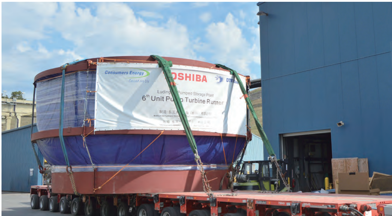
6台目用ポンプ水車ランナのラディントン揚水発電所到着 Sixth pump-turbine runner on arrival at Ludington Pumped Storage Plant, U.S.A.
