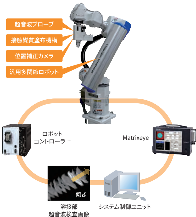
スポット溶接検査ロボットシステム Ultrasonic spot weld inspection robot system
