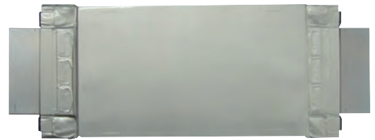
チタンニオブ酸化物負極を用いた試作電池
