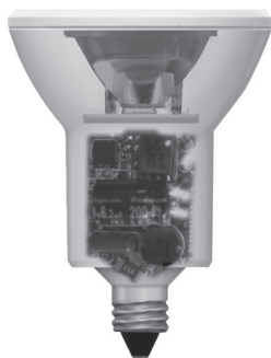
図10. 回路基板の小形化
