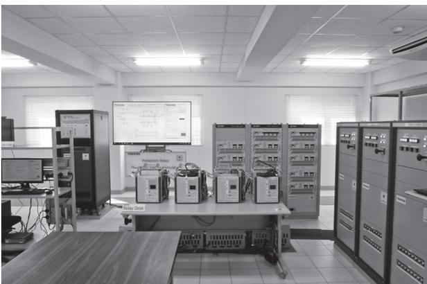
図6. 保護リレー運転訓練シミュレーター
