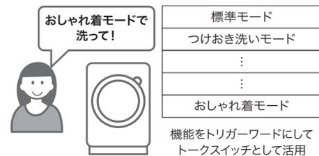
図3. ボイストリガー機能を使った音声操作
