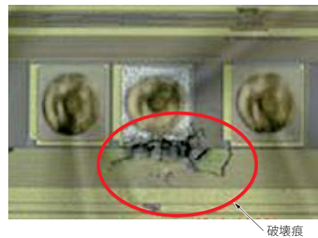
図2. ESDによる半導体デバイスの不良例
