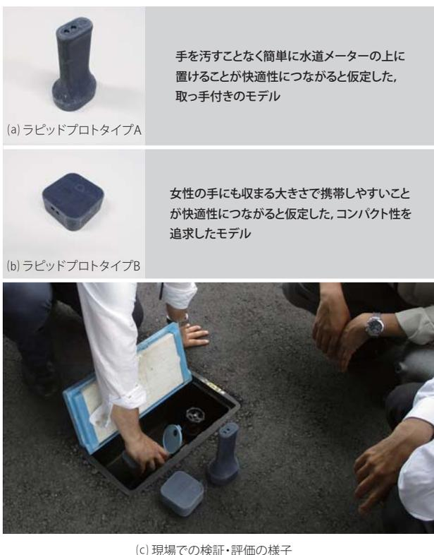
図2. ラピッドプロトタイプを用いた現場での検証・評価の様子
