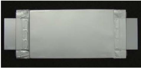
図2. 試作した電池
