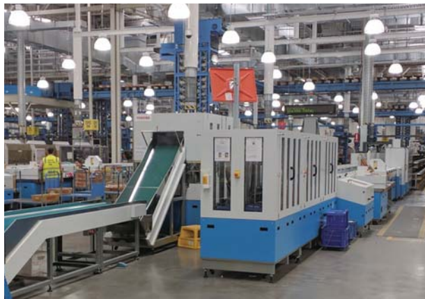
郵便物自動選別取り揃え押印機 TSR-1600 TSR-1600 culler-facer-canceller for Australian Postal Corporation
