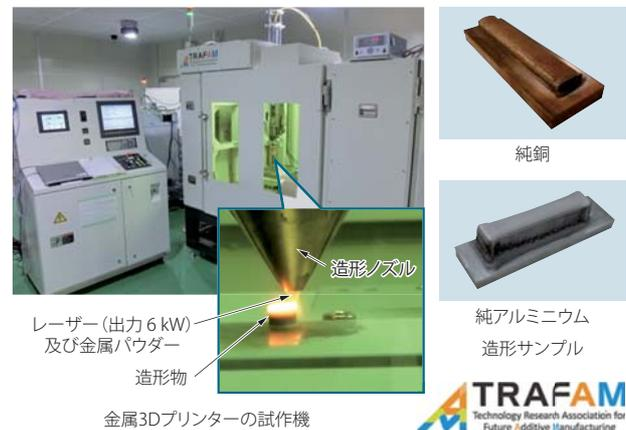
金属3Dプリンターの試作機及び造形サンプル
