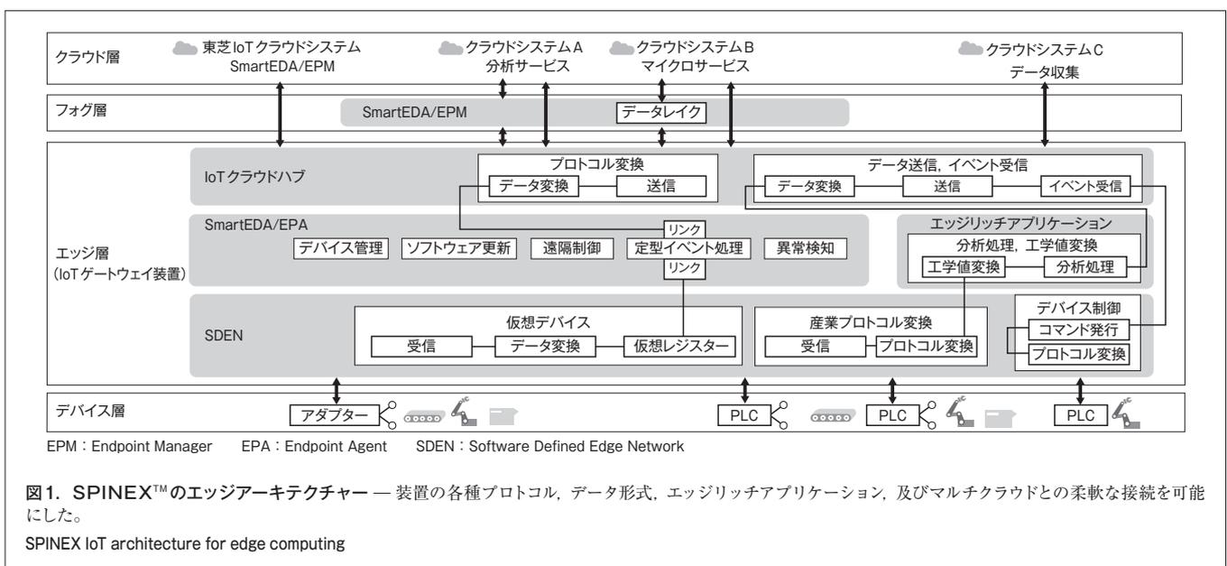
接続デバイスの制御などのインテリジェントな処理をエッジ側で行うSmartEDA/EPA (Endpoint Agent) から成るエッジアーキテクチャーを構築した (図1)。
