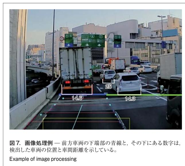
この画像処理によって算出された車頭間距離と、GPS情報などを、交通状況推定アルゴリズムに入力し、交通データを算出する。
