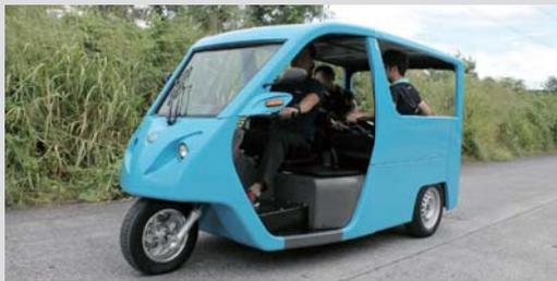
SCiB™ を搭載した渦潮電機（株）製電動三輪車 68 VM
