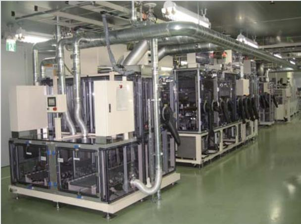
10 Ahセル及び20 Ahセル用の注液封止装置
