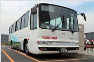
ワイヤレス受電装置を搭載した中型EVバス
