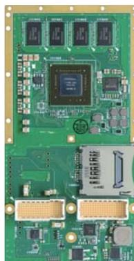
信号処理用 GPGPU 基板
