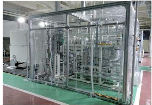
3  $\text{Nm}^3/\text{h}$  級 SOEC マルチセルスタック水素製造システム
