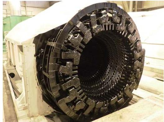
ジョフレ火力発電所 発電機固定子コイルの巻替工事
