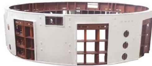
サンアガトン発電所用2号発電機の固定子枠
