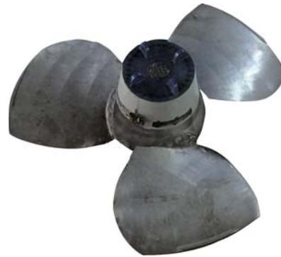
土谷塘発電所の3枚羽根バルブ水車
