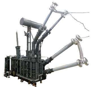
交直変換装置用変圧器の工場試験時のようすと定格諸元
