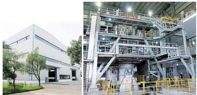
新鋳物工場建屋とLF炉及びVOD炉
