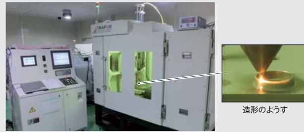
図1. 開発した試作機 — 試作機の外観(左)と、ステンレス(SUS316L)の金属パウダで直径30 mmの円筒を造形している様子(右)です。高速な造形が可能なLMD方式を採用しています。
