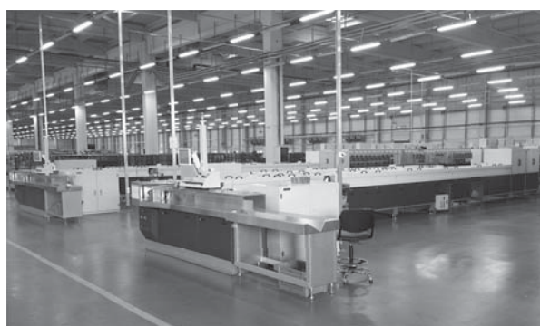
図1. セルビア郵政公社へ納入した郵便区分機(一部) — セルビア初の郵便自動処理システムであり、2015年12月から稼働している。
