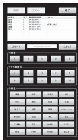
図1. タブレット画面に表示された時間分析ツール — タブレット上で作業工数の記録や、集計、グラフ表示などができ、IEの基本となる分析の一つである時間分析(連続時間分析及びワークサンプリング)での集計や分析の負荷を削減できる。
