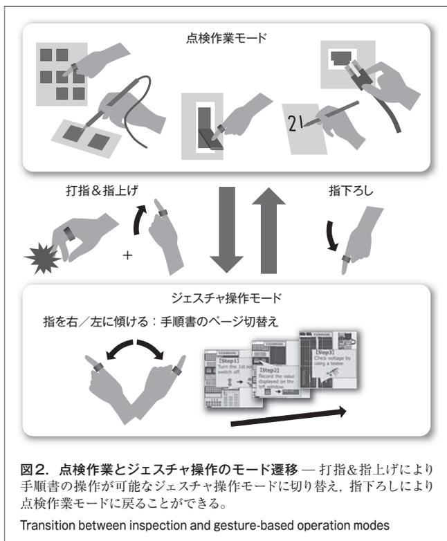
“ジェスチャ操作モード”に移行して手順書を指ジェスチャで操作する。その後、ページ切替えのジェスチャを受け付けられない点検作業モードに戻ることで保守点検作業を再開できる。
