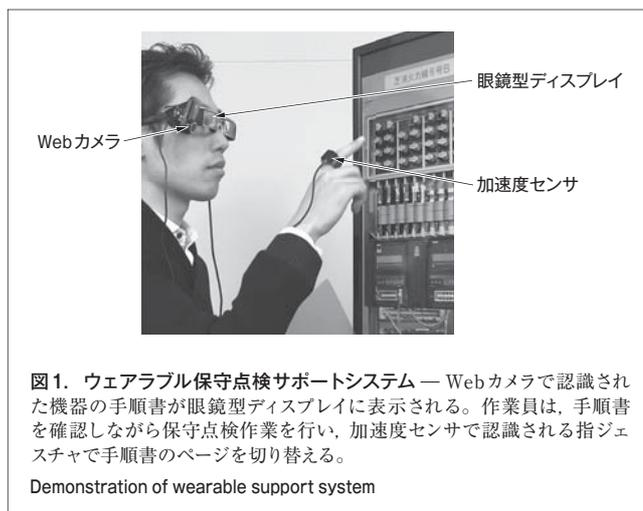
図1. ウェアラブル保守点検サポートシステム — Webカメラで認識された機器の手順書が眼鏡型ディスプレイに表示される。作業員は、手順書を確認しながら保守点検作業を行い、加速度センサで認識される指ジェスチャで手順書のページを切り替える。
