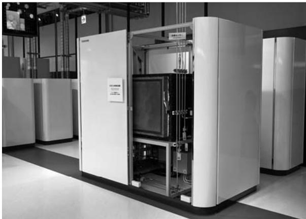
図5. SOECマルチスタック評価ユニット — 水素エネルギー研究開発センター内に設置され、10 kW以上の規模でSOECの特性評価ができる。SOEC multi-stack evaluation unit
