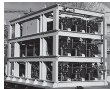
図6. 水素吸蔵合金タンク — タンクは複数個で構成されており、フレームに納められている。 Hydrogen storage alloys tank
