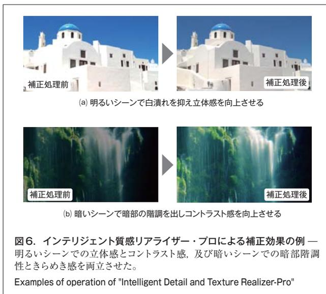
の比較)に増やし、映像の特徴に応じて最適な輝度変換テーブルを使用して、暗いシーンでの暗部階調性ときらめき感、並びに明るいシーンでの立体感とコントラスト感を両立させている(図6)。
