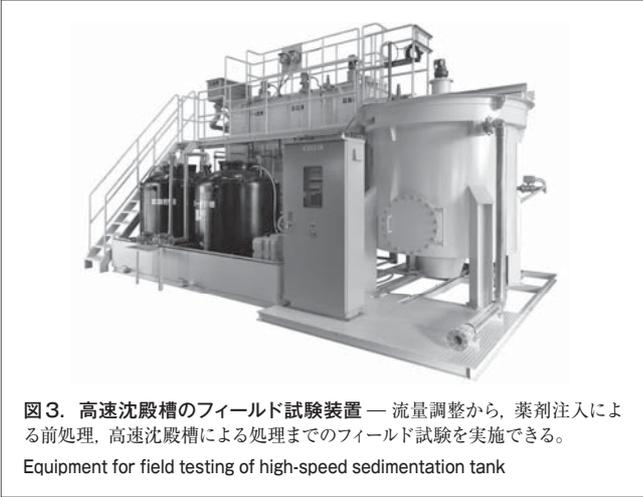
図3. 高速沈殿槽のフィールド試験装置 — 流量調整から、薬剤注入による前処理、高速沈殿槽による処理までのフィールド試験を実施できる。
