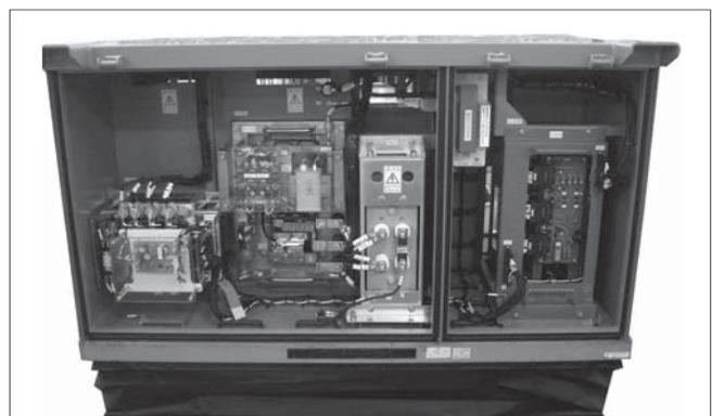
図5. IGBT界磁チョッパ装置 — 1983年に納入したGTOを使用した直流主電動機駆動用界磁チョッパ装置の更新用装置を、IGBTを使って作製した。
