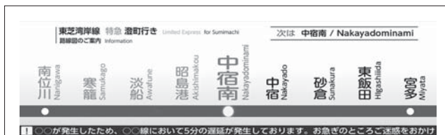
図5. 路線図案内の例 — 横長LCD車内案内表示器の画面で、一度に表示しきれない場合には、スクロールして表示を行う。
