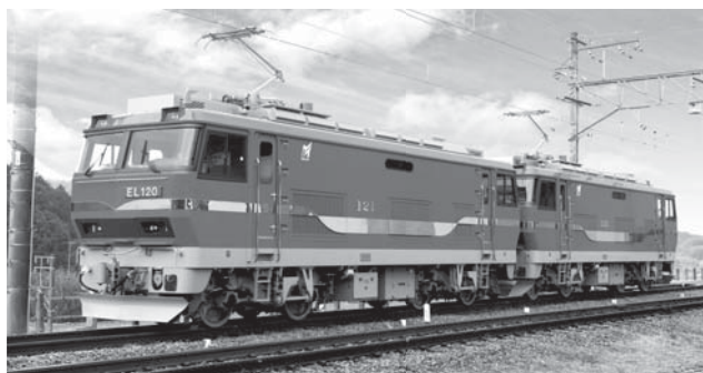
図7. EL120形直流電気機関車(重連時) — 名古屋鉄道(株)に納入したEL120形電気機関車である。 Double-headed EL120 DC electric locomotive
